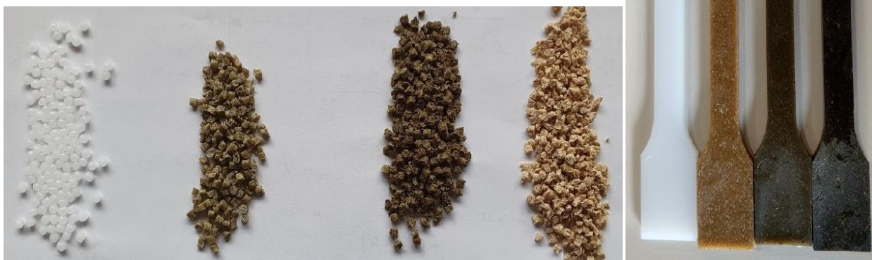
Figuur 4 Biocomposiet met lievalen, granulaat en trekstaven
